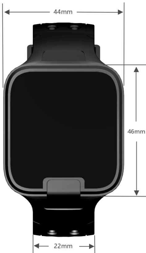
图 4-1 VDU1502-PBR 正面尺寸 ( \pm 1\text{mm} )
